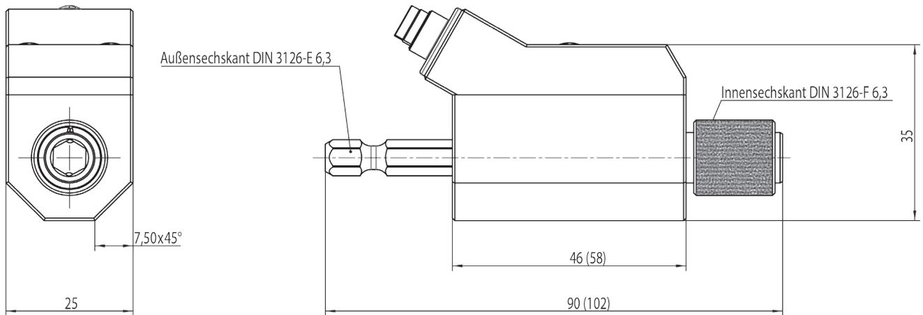
In Klammer gesetzte Maße bei Option Drehwinkel. / Allgmeintoleranzen nach DIN 2768-m.
