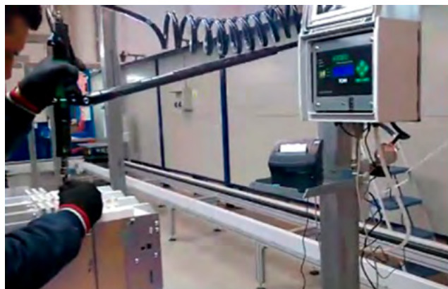
Prozess unter Kontrolle und Ausdruck der Schraubergebnisse
