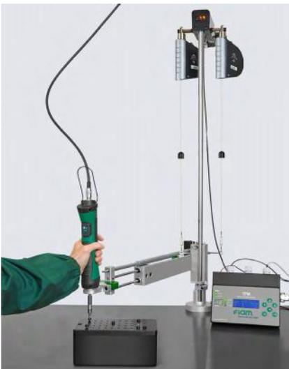
Werkzeughalter mit Vorrichtung zur Positionserkennung
