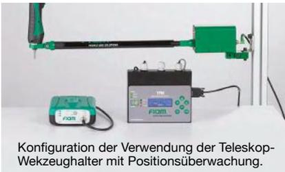
Konfiguration der Verwendung der Teleskop-Werkzeughalter mit Positionsüberwachung.
