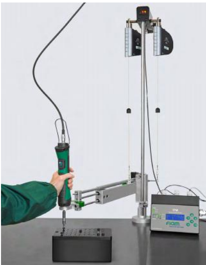
Werkzeughalter mit Vorrichtung zur Positionserkennung
