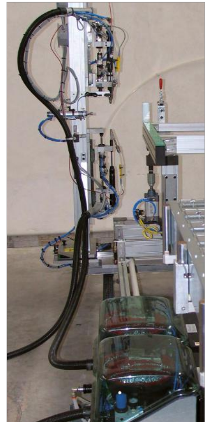
Mehrfach-MCA für den Rahmenbereich: gleichzeitige Montage von oben nach unten und von unten nach oben
