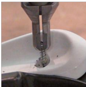
Beispiele für Spezialköpfe mit Reibungsbacken, um zu Verschraubungspunkten in der Tiefe, an unzugänglichen Stellen oder in sehr engen Löchern zu gelangen.
