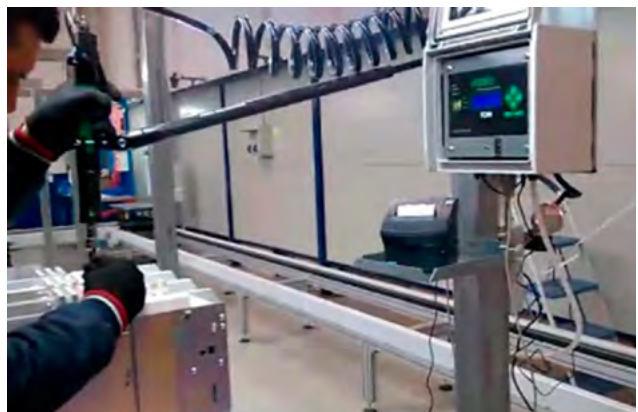
Prozess unter Kontrolle und Ausdruck der Schraubergebnisse
